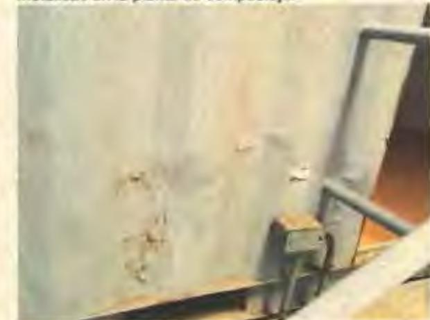
Fotos 5 y 6: Contenedores utilizados en taller de mantención de máquinas y equipos presentan en su superficie diversas imperfecciones y daños tales como abolladuras y procesos de oxidación.
